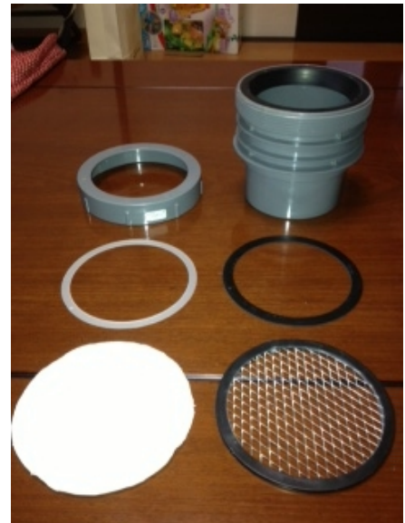
濾紙ヘッド部のフィルター固定部品
